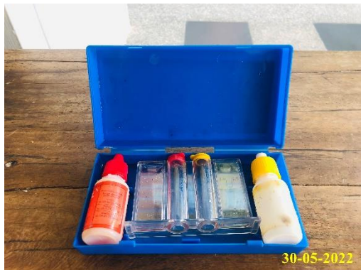
ภาพที่ 3.5.4-1 แสดงการตรวจวัด pH และ Free Chlorine
