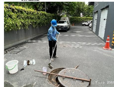
การเก็บตัวอย่างน้ำจุดน้ำเสียเข้าจากระบบบำบัดน้ำเสีย
