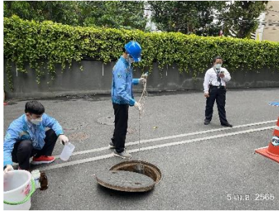
การเก็บตัวอย่างน้ำจุดน้ำเสียออกจากระบบบำบัดน้ำเสีย
