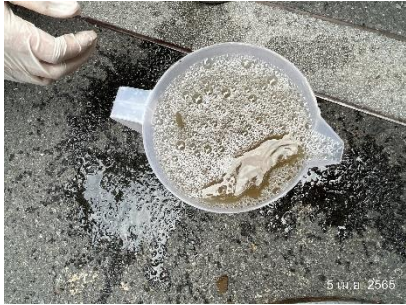
การเก็บตัวอย่างน้ำจุดน้ำเสียออกจากระบบบำบัดน้ำเสีย
