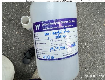
การเก็บตัวอย่างน้ำจุดน้ำเสียเข้าจากระบบบำบัดน้ำเสีย
