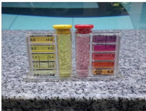
ภาพที่ 3.5.4-2 วิธีการตรวจวัด pH และ Chlorine
