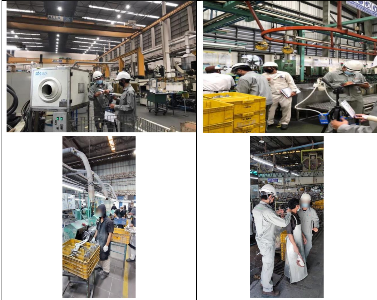
รูปที่ 3.4.7-4 ตัวอย่างการตรวจวัดคุณภาพอากาศในบริเวณพื้นที่การทำงาน
