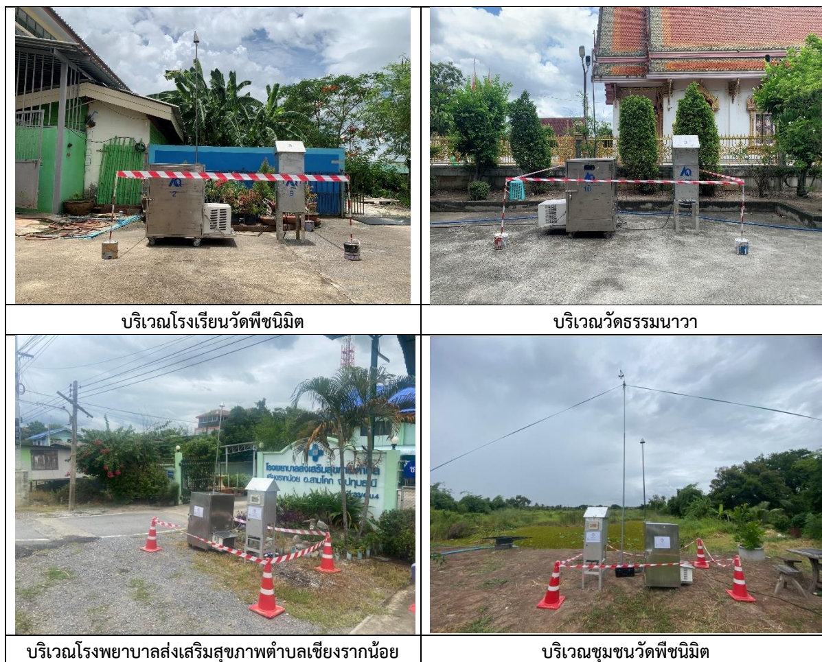
รูปที่ 3.4.1-1 การเก็บตัวอย่างคุณภาพอากาศในบรรยากาศ
