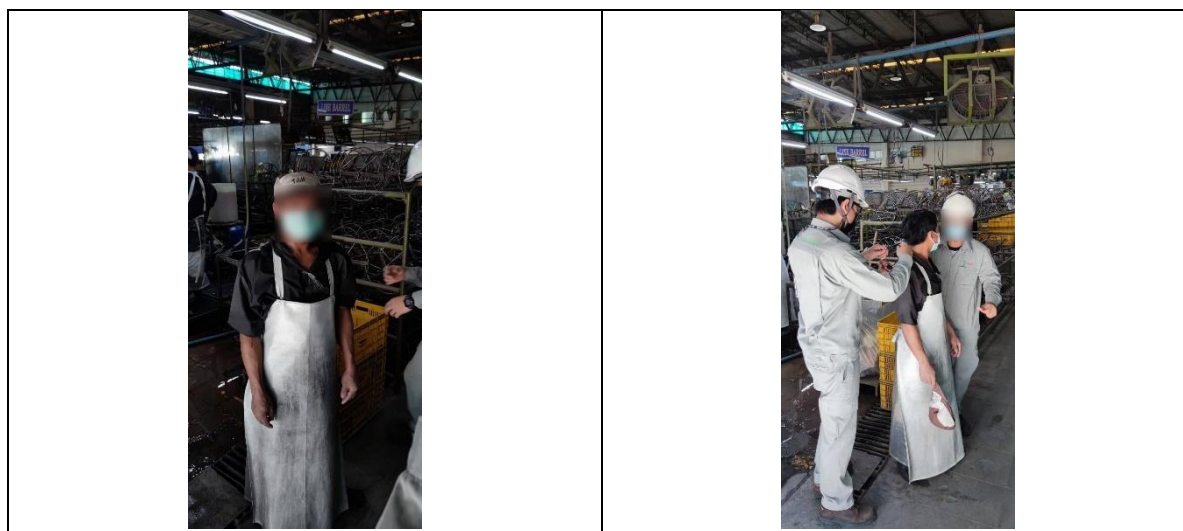
รูปที่ 3.4.7-5 ตัวอย่างการตรวจวัดระดับเสียงสะสมติดตัวพนักงาน
