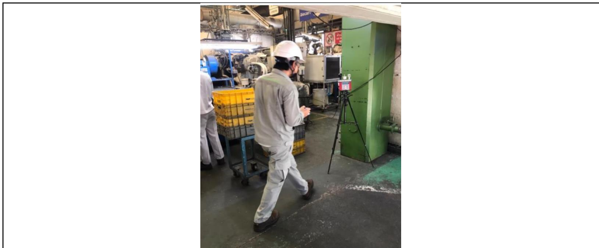
รูปที่ 3.4.7-2 ตัวอย่างการตรวจวัดค่าดัชนีความร้อน
