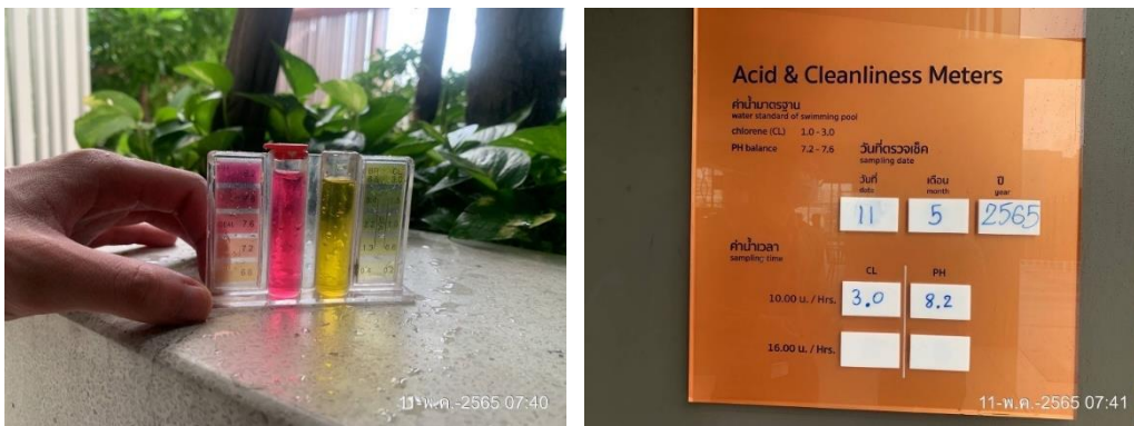
ภาพที่ 3.5.4-2 การตรวจวัด pH และ Cl_2 สระว่ายน้ำ
