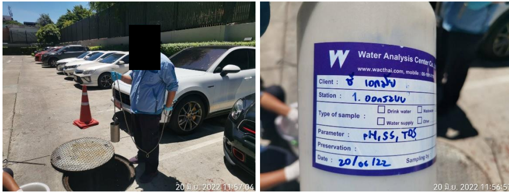
การเก็บตัวอย่างน้ำที่ออกจากระบบบำบัดน้ำเสีย
