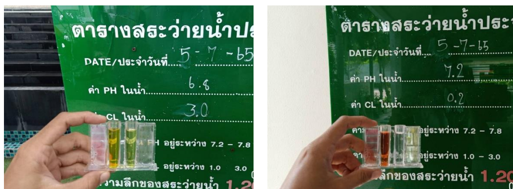
ภาพที่ 3.5.5-2 การตรวจวัด pH และ CL2 สระว่ายน้ำ
