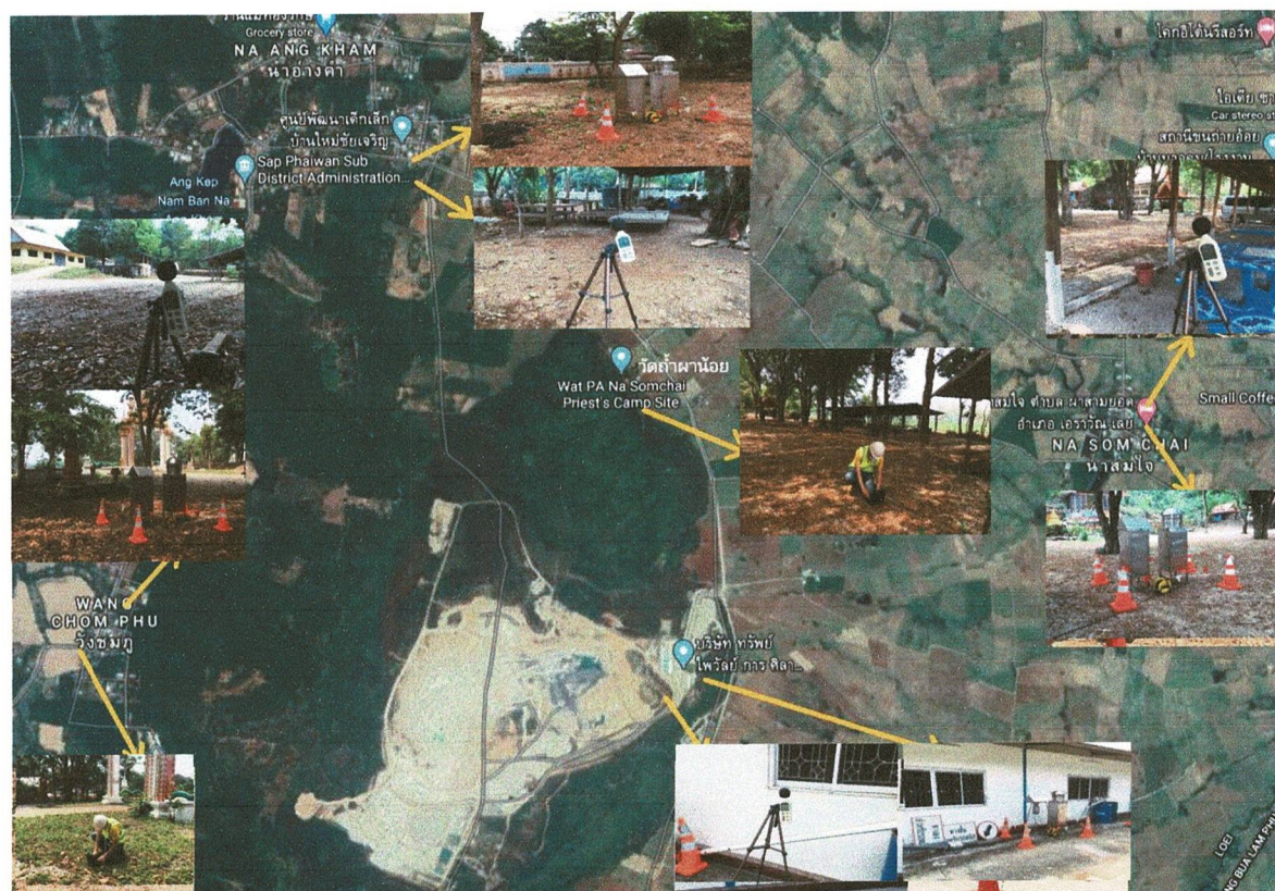
รูปที่ 3-1 จุดตรวจวัดปริมาณฝุ่นละออง ความทึบแสง ระดับเสียงและความสั่นสะเทือน
