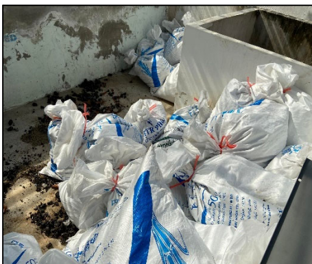
ภาพที่ 3.28 การเก็บรวบรวมกากตะกอน จากระบบบำบัดน้ำเสีย
