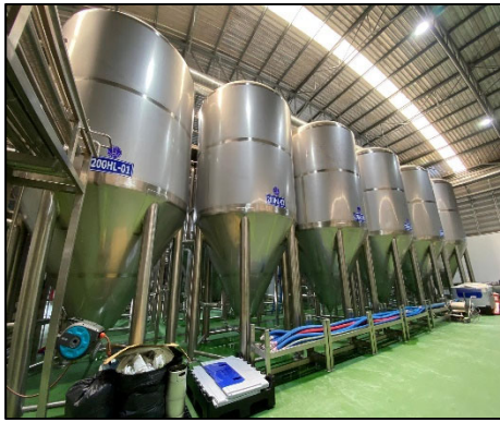
ภาพที่ 3.1 ถังหมัก/บ่มเพื่อผลิตเบียร์ ของโครงการที่มีการปิดมิดชิด
