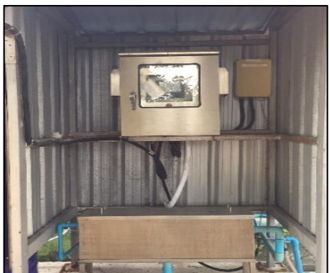
ภาพที่ 3.15 เครื่องวัด BOD/COD แบบต่อเนื่อง
