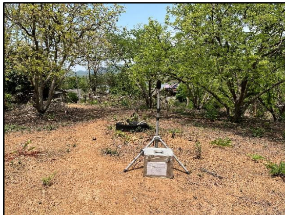
ภาพที่ 3.12 การตรวจวัดระดับเสียง บริเวณ ชุมชนลำเภาทอง
