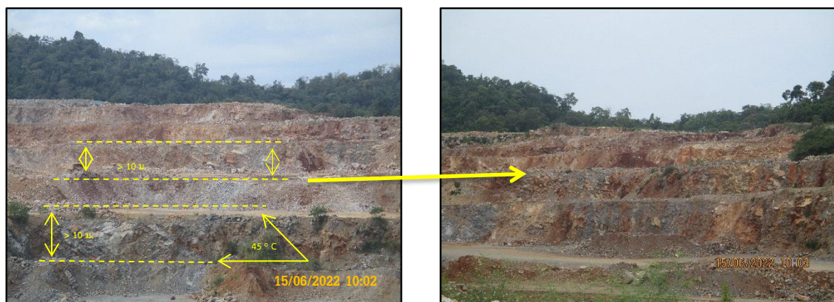
ภาพที่ 2.2 การทำเหมืองแบบขั้นบันได (Benching Method)
