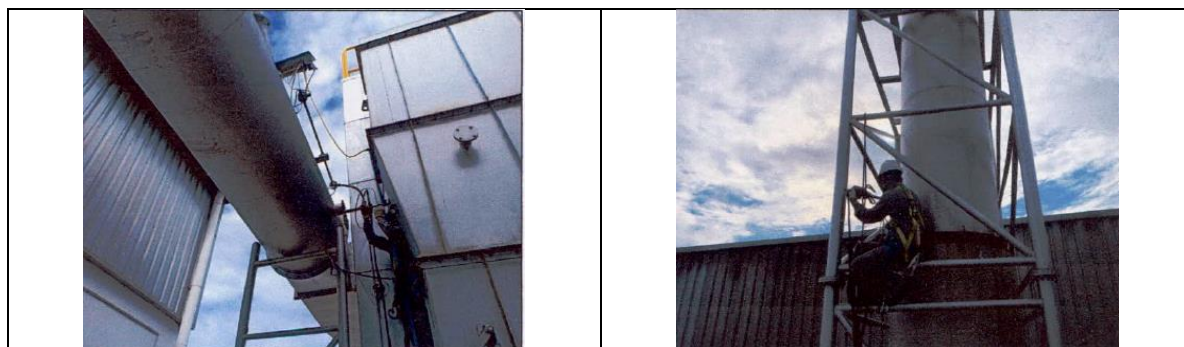
รูปที่ 3.5.1-1 การเก็บตัวอย่างปล่องระบายอากาศเสียจาก Bag Filter ชุดที่ 1 บริเวณอาคาร Diecast 1 (DC1) เมื่อวันที่ 13 พฤษภาคม 2565
