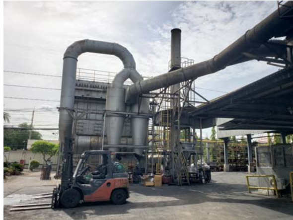
ระบบดักฝุ่นละอองแบบถุงกรอง
