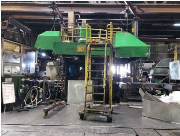
ระบบดูดอากาศเพื่อรวบรวมละอองน้ำมัน จาก Hot Rolling ออกจากปล่องระบาย
