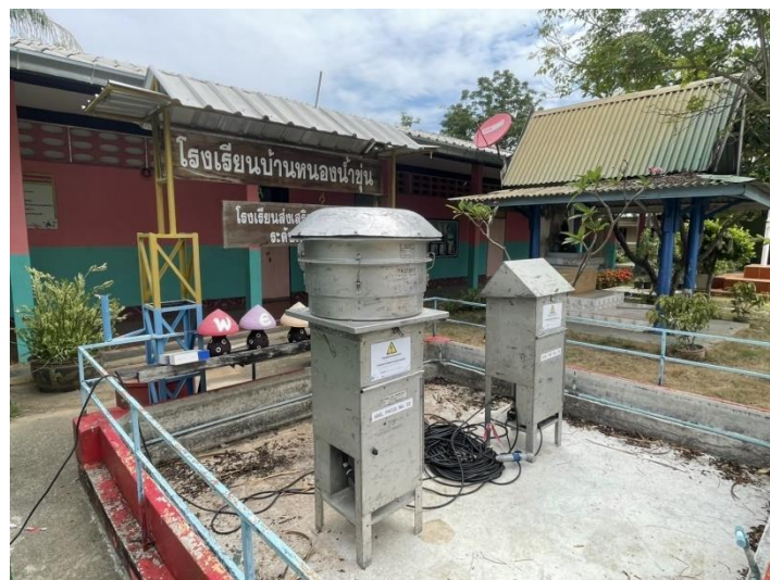
รูปที่ 1-1-2 การตรวจวัดฝุ่นละออง พิกัด 560604E, 1530387N (5 พฤษภาคม 2565)
