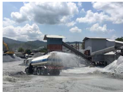
รูปที่ 2-6: การฉีดพรมน้ำบริเวณโรงโม่หิน
