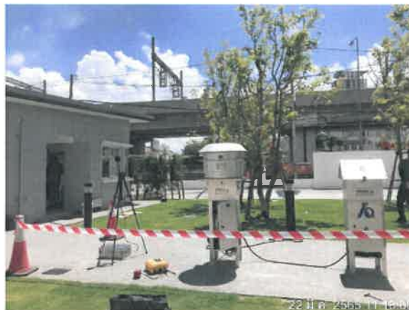
รูปที่ 2-8 แสดงอุปกรณ์ตรวจวัดคุณภาพอากาศ เสียง และความสั่นสะเทือน
