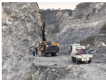
รูปที่ 2-6: รถทุบกระแทกหิน
