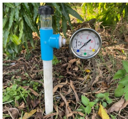
รูปที่ 129 การติดตั้งเครื่อง Tensiometer วัดความชื้นของดิน
