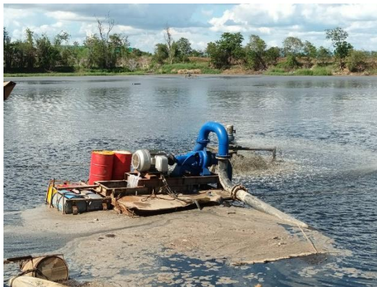
รูปที่ 66 เครื่องสูบน้ำตะกอนเหลว จากระบบบำบัดน้ำเสีย
