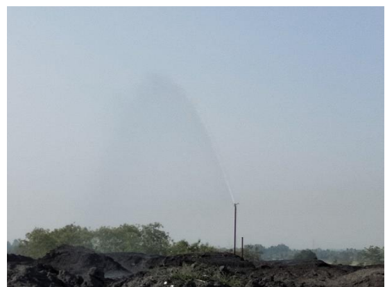
รูปที่ 38 การฉีดพรมน้ำฝอยบนลานกองถ้ำ
