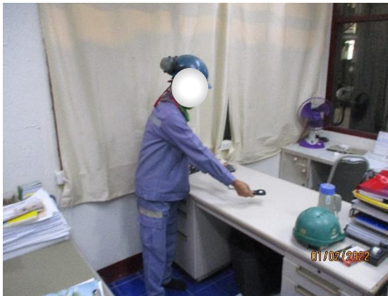
รูปที่ 3.4-20 การตรวจวัดค่าความเข้มของแสงสว่างในสถานประกอบการ
