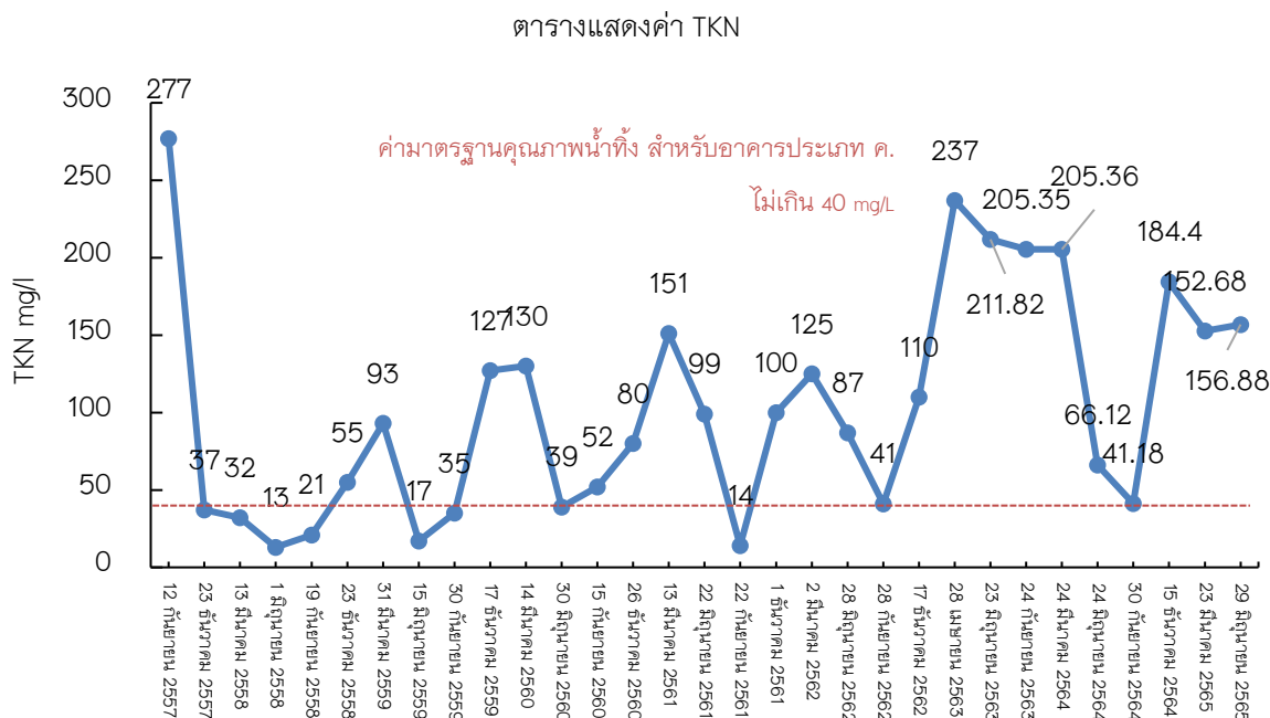
ภาพที่ 22 แสดงแนวโน้มค่า TKN ของน้ำทิ้งที่ผ่านระบบบำบัดน้ำแล้วในการติดตามตรวจสอบระหว่างปี พ.ศ. 2557 ถึง พ.ศ.2565
