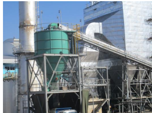
รูปที่ 17 สายพานลำเลียงถ้ำแบบปิดครอบ
