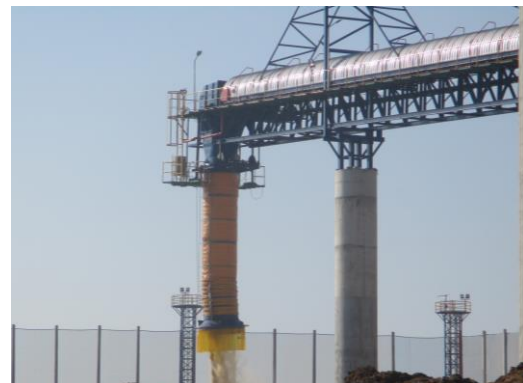
รูปที่ 11 ครอบกันฝุ่น กรณีโปรยกากอ้อยลงสู่กองเก็บกากอ้อย
