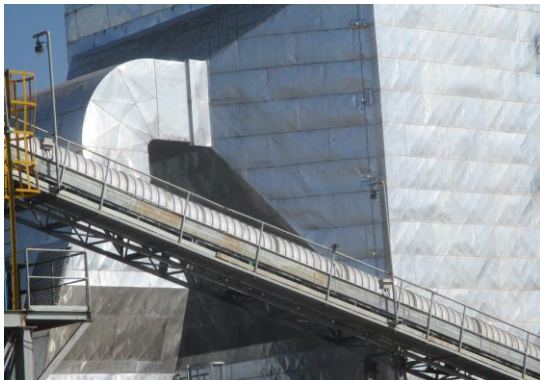
รูปที่ 17 สายพานลำเลียงถ้ำแบบปิดครอบ
