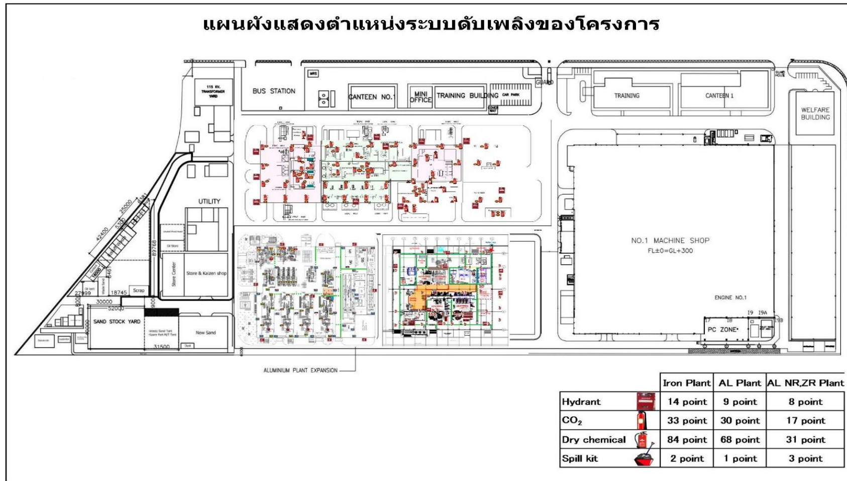
รูปที่ 1.10-1 แผนผังแสดงตำแหน่งระบบดับเพลิงของโครงการ
