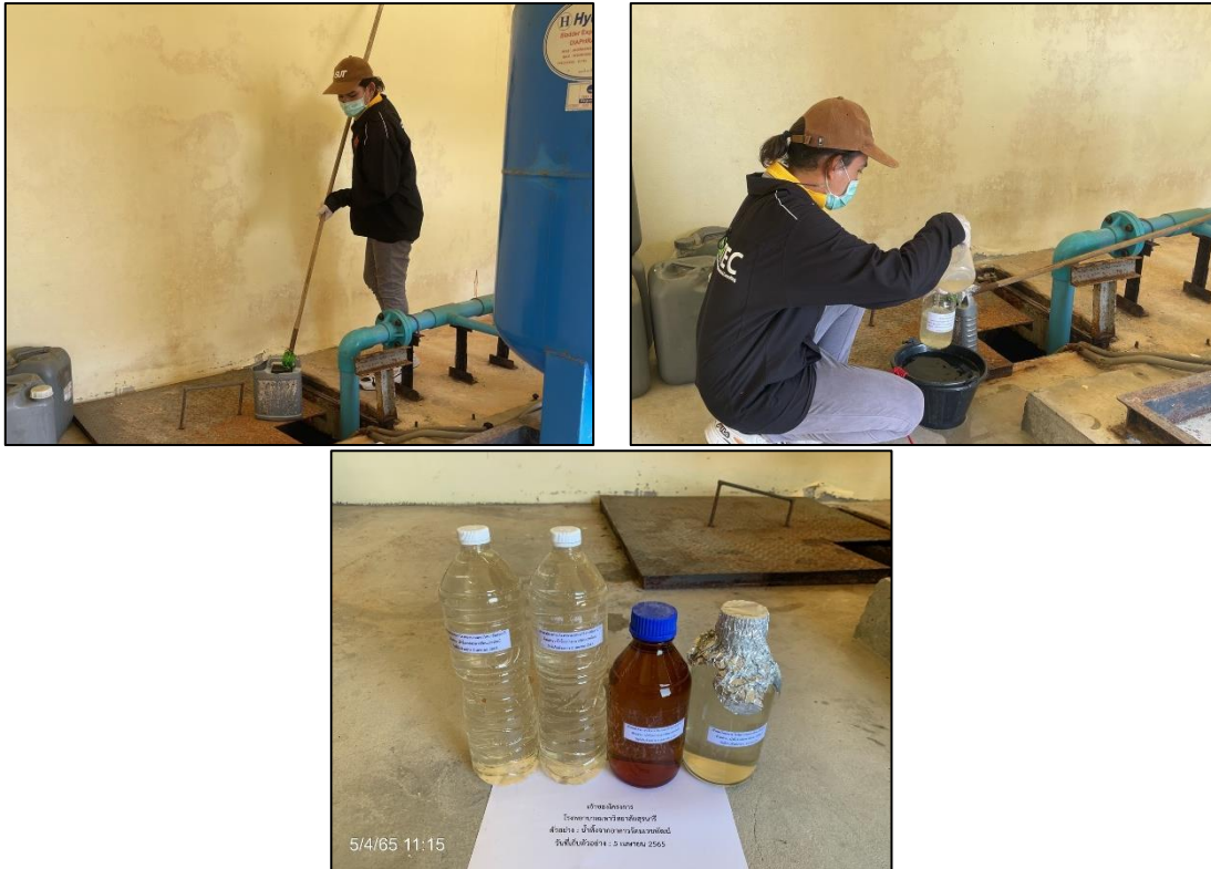
ข.การเก็บตัวอย่างน้ำทิ้งจากระบบบำบัดน้ำเสียอาคารรัตนเวชพัฒน์
