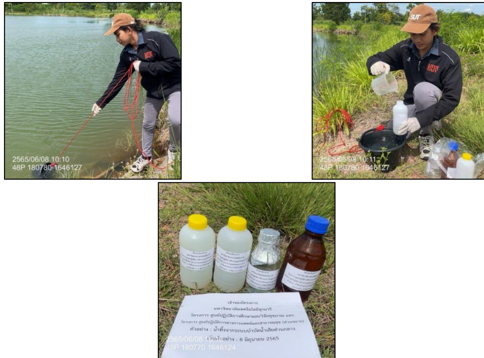
ข. การเก็บตัวอย่างน้ำทิ้งของระบบบำบัดน้ำเสียส่วนกลาง
