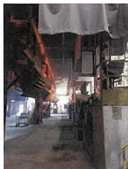
ภาพที่ 2-1 ระบบรวบรวมฝุ่นแบบ Canopy hood
