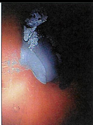
Fig.24 เมื่อทำการบัดกรีแล้ว พบว่ามีสิ่งสกปรกค้างในท่อ ประมาณ 10 - 20 % ของท่อ
