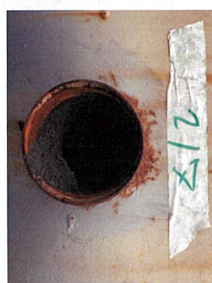
Fig.4 เมื่อทำการฉีดน้ำแล้ว พบว่ามีน้ำซึมออกมาประมาณ 50 % ของน้ำ
