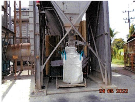
ภาพที่ 2-20 ถุงจัมโบ้ (big bag) สำหรับรวบรวมฝุ่นจากระบบดักฝุ่นแบบถุงกรอง
