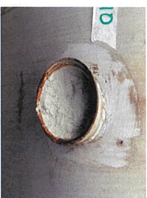
Fig.4 เมื่อทำการเปิดดูแล้ว พบว่ามีหินที่ตกค้างในท่อ มากเกิน 50 % ของท่อ
