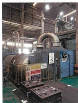
ภาพที่ 2-5 ระบบดูดอากาศเฉพาะจุด
