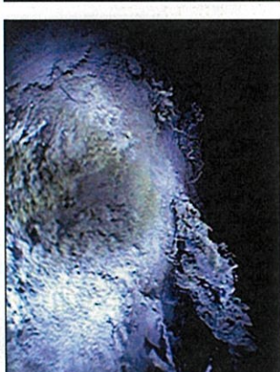
Fig.12 เมื่อทำการเปิดดูแล้ว พบว่ามีพื้นที่กัดกร่อนในแนว ประมาณ 50 % ของท่อ
