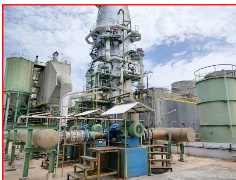
ภาพที่ 2.2-18 ระบบ Sea Water Scrubber
