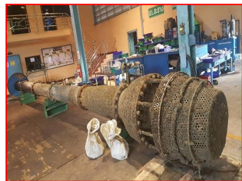
ภาพที่ 2.2-19 ตะแกรงกรองขนาด 16 มิลลิเมตร ที่หัวเครื่องสูบน้ำทะเล
