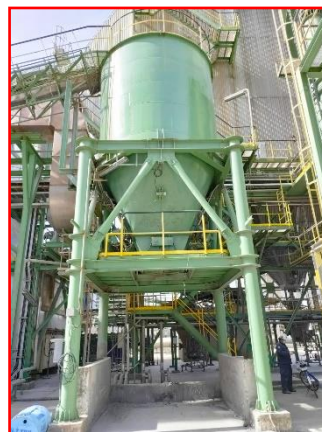
ภาพที่ 2.2-28 ซิโหลหรือ Collecting Pit เก็บถ้ำหนัก แบบปิด
