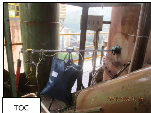
ภาพที่ 3.2 การตรวจวัดคุณภาพอากาศจากปล่องหม้อเผา 4
