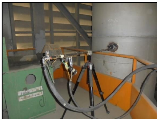
ภาพที่ 3.7 การตรวจวัดคุณภาพอากาศจาก ปล่องหม้อบดซีเมนต์ 9
