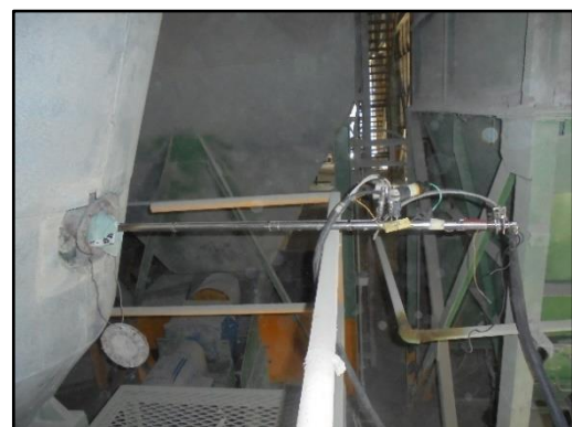
ภาพที่ 3.6 การตรวจวัดคุณภาพอากาศจาก ปล่องหม้อบดซีเมนต์ 7
