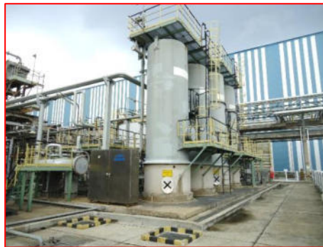
ภาพที่ 2.2-6 อุปกรณ์กำจัดปรอท (MRU)
