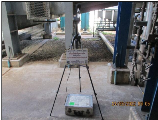
รูปที่ 3.9 การตรวจวัดระดับเสียงในพื้นที่ทำงาน บริเวณ HRSG 3 - East
