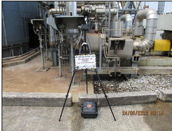
รูปที่ 3.12 การตรวจวัดระดับเสียงในพื้นที่ทำงาน บริเวณ Boiler Feed Pump
