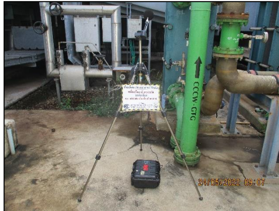
รูปที่ 3.8 การตรวจวัดระดับเสียงในพื้นที่ทำงาน บริเวณ HRSG 3 – West
