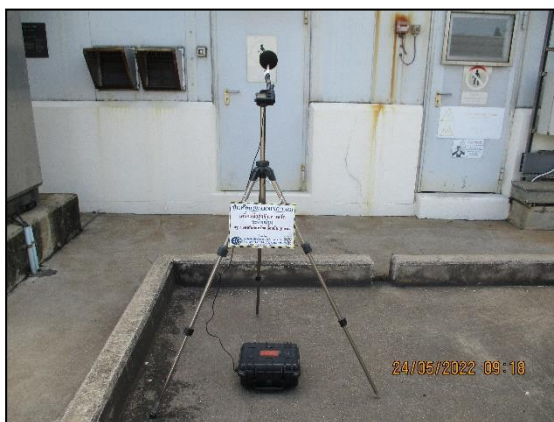
รูปที่ 3.10 การตรวจวัดระดับเสียงในพื้นที่ทำงาน บริเวณ Gas Turbine 3 – North
