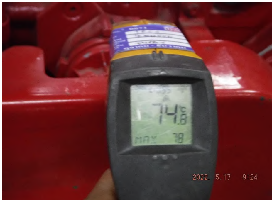
รูปที่ 2 อุณหภูมิของเครื่องยนต์ 74.8 องศาเซลเซียส
