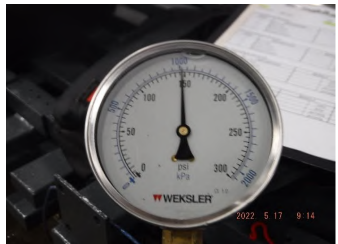
รูปที่ 8 Discharge Pressure ที่อ่านค่าได้เท่ากับ 146 psi.
