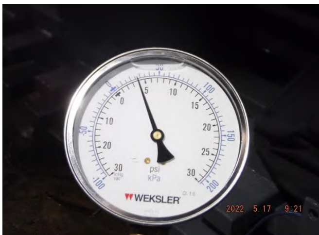
รูปที่ 23 Suction Pressure ที่อ่านค่าได้เท่ากับ 4 psi.
