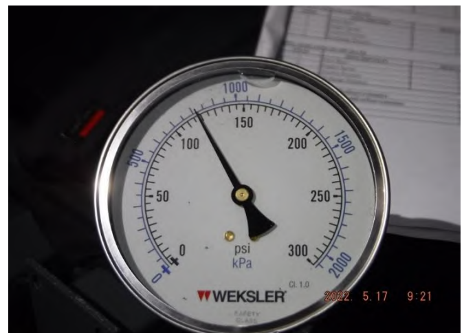
รูปที่ 24 Discharge Pressure ที่อ่านค่าได้เท่ากับ 119 psi.
