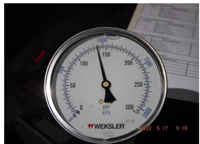
รูปที่ 16 Discharge Pressure ที่อ่านค่าได้เท่ากับ 135 psi.
