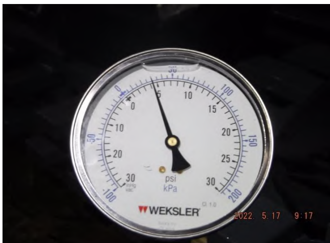
รูปที่ 11 Suction Pressure ที่อ่านค่าได้เท่ากับ 4.2 psi.
