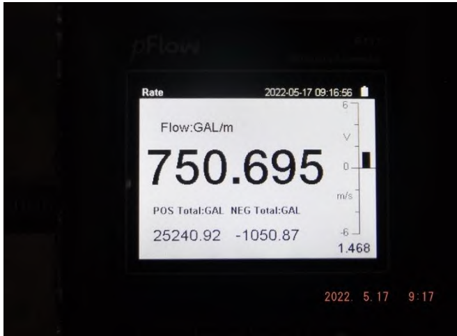
รูปที่ 9 อัตราการไหล (Flow Rate) ที่อ่านค่าได้ เท่ากับ 750.695 แกลลอนต่อนาที (gpm.)
