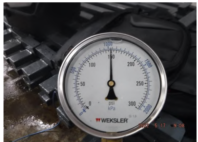
รูปที่ 4 Discharge Pressure ที่อ่านค่าได้เท่ากับ 150 psi.
