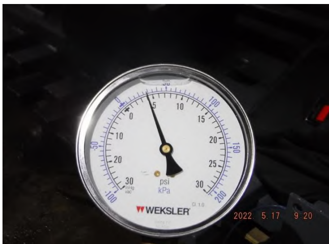
รูปที่ 19 Suction Pressure ที่อ่านค่าได้เท่ากับ 4 psi.
