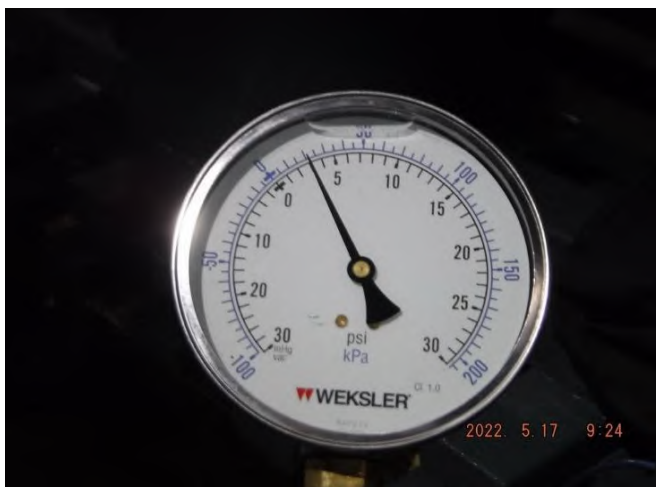
รูปที่ 27 Suction Pressure ที่อ่านค่าได้เท่ากับ 3 psi.
