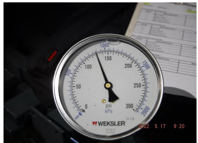
รูปที่ 20 Discharge Pressure ที่อ่านค่าได้เท่ากับ 129 psi.
