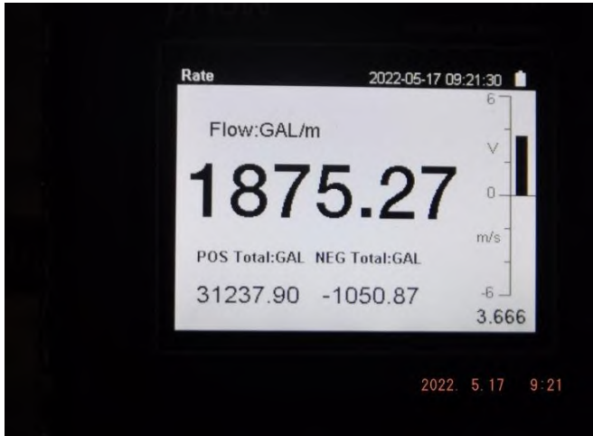
รูปที่ 21 อัตราการไหล (Flow Rate) ที่อ่านค่าได้ เท่ากับ 1,875.27 แกลลอนต่อนาที (gpm.)
