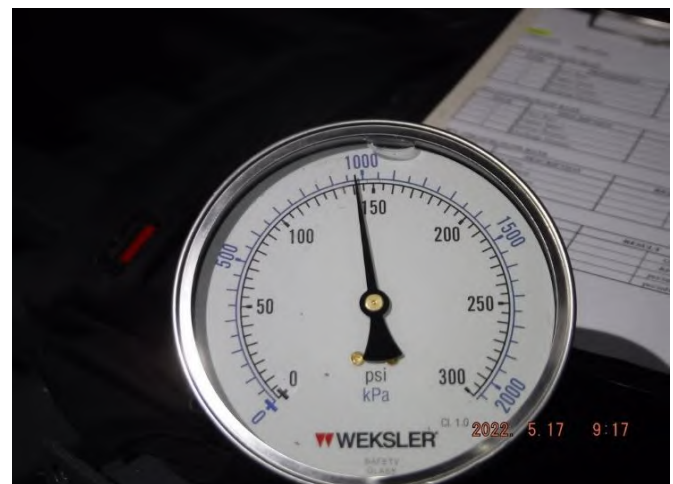
รูปที่ 12 Discharge Pressure ที่อ่านค่าได้เท่ากับ 141 psi.
