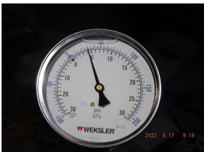
รูปที่ 15 Suction Pressure ที่อ่านค่าได้เท่ากับ 4.2 psi.
