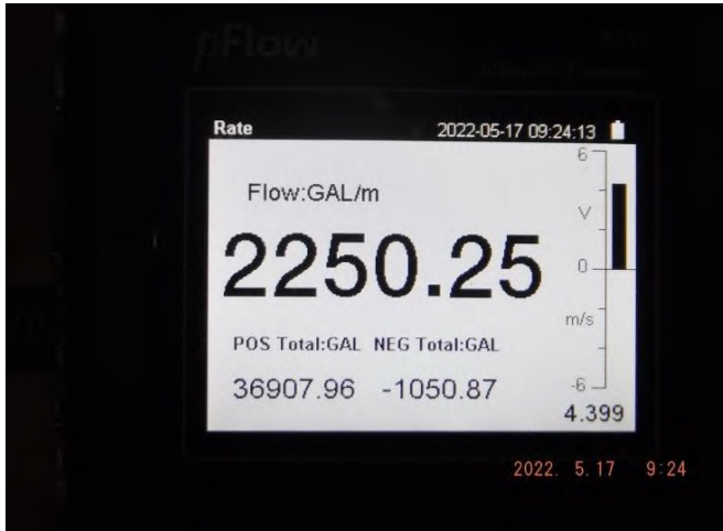
รูปที่ 25 อัตราการไหล (Flow Rate) ที่อ่านค่าได้ เท่ากับ 2,250.25 แกลลอนต่อนาที (gpm.)
