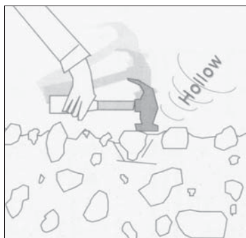
รูปที่ ผ3-3 การตรวจสอบเบื้องต้นหลังจากการสกัดคอนกรีตที่เสียหายออก (ที่มา: Concrete Repair and Maintenance Illustrated) (ข้อ ผ3.3)
