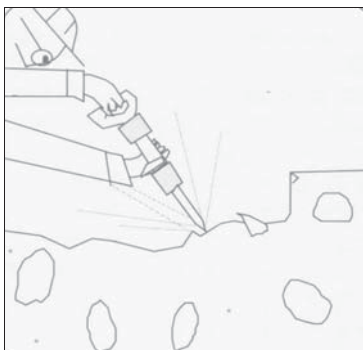
รูปที่ ผ3-2 การสกัดคอนกรีตที่เสียหายออก (ที่มา: Concrete Repair and Maintenance Illustrated) (ข้อ ผ3.2)
