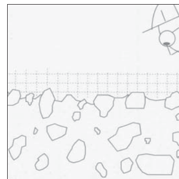
รูปที่ ผ3-5 การตรวจสอบสภาพพื้นผิวอีกครั้งหลังจากการสกัดคอนกรีตที่เสียหายออกครั้งที่สอง (ที่มา: Concrete Repair and Maintenance Illustrated) (ข้อ ผ3.5)
