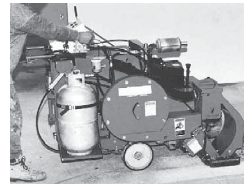
รูปที่ 12 การสกัดด้วยการพ่นอนุภาคโลหะ (Shotblasting) (ต่อ) (ที่มา: ACI 555) (ข้อ 5.2.2.4)
