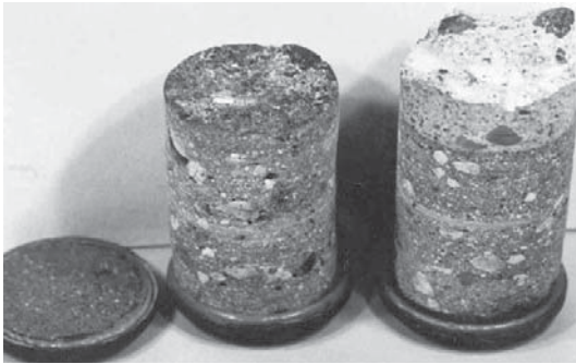
รูปที่ 31 แท่งคอนกรีตที่ผ่านการทดสอบการหดตัวของคอนกรีต (ที่มา: ACI 555) (ข้อ 6.7.1)
