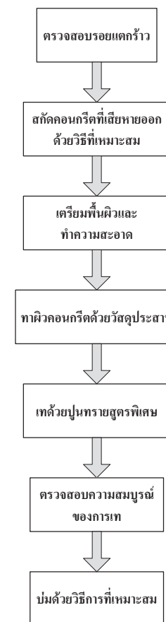
รูปที่ 48 ขั้นตอนวิธีการเททับผิวหน้า และการซ่อมแซมผิวด้วยปูนซีเมนต์ปอร์ตแลนด์ (ข้อ 7.6)
