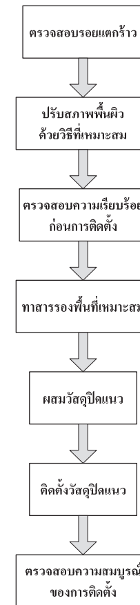
รูปที่ 47 ขั้นตอนวิธีการซ่อมแซมแบบทำแนวและอุดแนวบริเวณรอยร้าว (Routing และ Sealing) (ข้อ 7.4.3.6)
