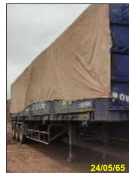
รูปที่ 2-10 การปิดคลุมรถบรรทุกเชื้อเพลิงชีวมวล
