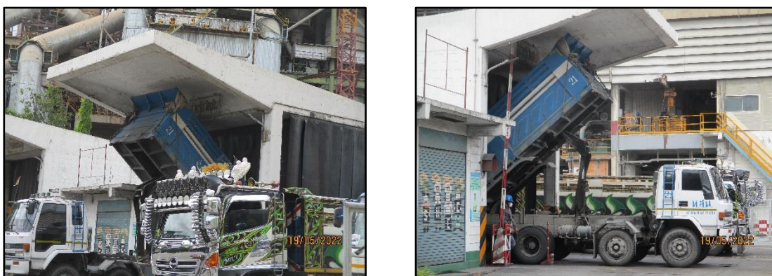
ภาพที่ 2.40 อ่างรับวัตถุดิบที่มีม่านยางป้องกันการฟุ้งกระจายของฝุ่นละออง
