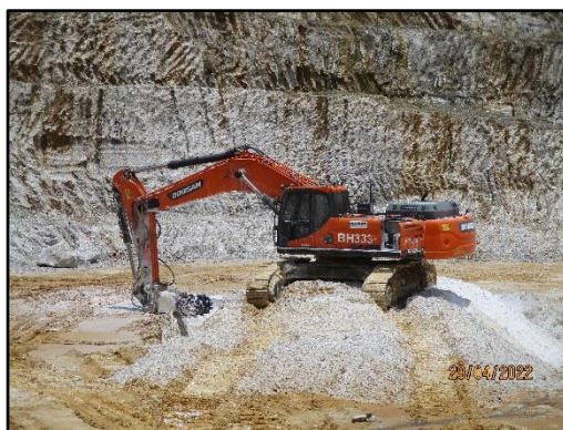
ภาพที่ 2.5 การนำ Hydraulic Breaker ติดห้วงัดมาใช้ในการทำเหมือง
