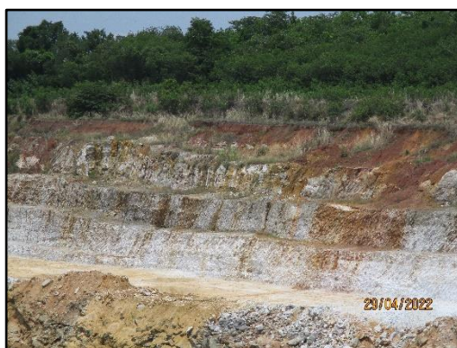
ภาพที่ 2.4 การเปิดหน้าเหมืองในแบบลักษณะชั้นบันได
