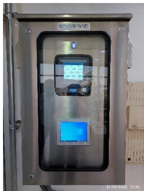
รูปที่ 10 เครื่องตรวจวัดคุณภาพน้ำอัตโนมัติ
