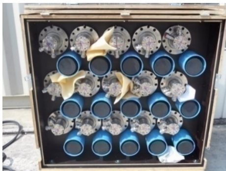
ภาพที่ 2.2-2 อุปกรณ์ Burner ในระบบหัวฉีดเผาไหม้แบบ Dry Low NOx
