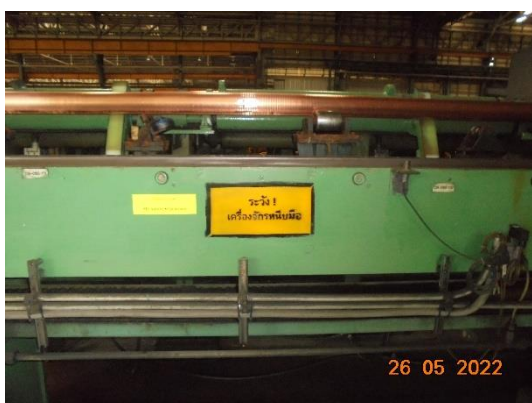
รูปที่ 53 การ์ดป้องกันอันตรายจากเครื่องจักร
