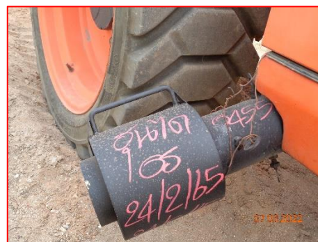
ภาพที่ 2.2-31 รถยนต์ของบริษัทผู้รับเหมา ได้ติดตั้งอุปกรณ์ป้องกันประกายไฟ ก่อนเข้าเขตผลิตหรือเขตควบคุม
