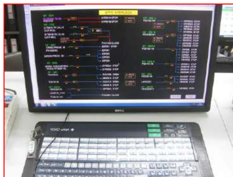
ภาพที่ 2.2-3 ระบบ Inter Lock ของระบบ ESP
