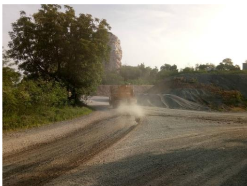
รูปที่ 6 การฉีดพรมน้ำเส้นทางขนแร่
