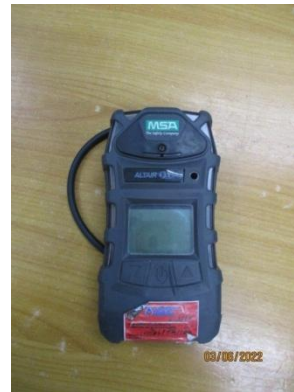
รูปที่ 53 Combustible Gas Detector
