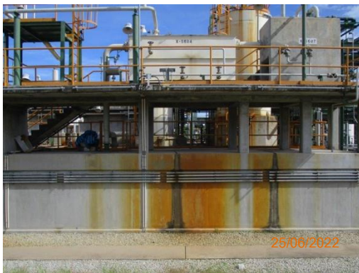
รูปที่ 9 ถังแยกน้ำมันแบบ CPI Oil Separator
