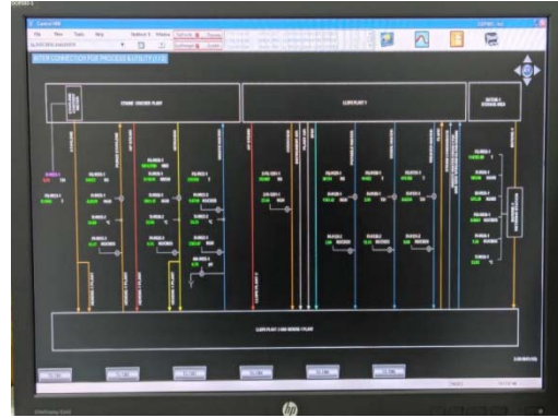
รูปที่ 60 หน้าจอควบคุมความดันและ อัตราการไหลของสารในท่อ
