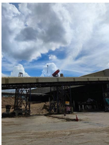
รูปที่ 16 การฟ่นละอองน้ำเพื่อลดฝุ่นจากลานกองเก็บเชื้อเพลิง
