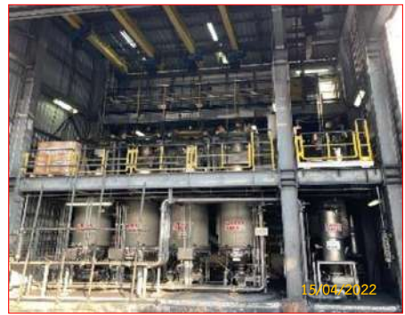
ภาพที่ 2.2-41 ระบบ Dumping Station ของ Carbon Black
