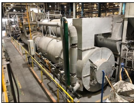
รูปที่ 2-5 ระบบ After Burnner ที่เตาอบเศษซาก
