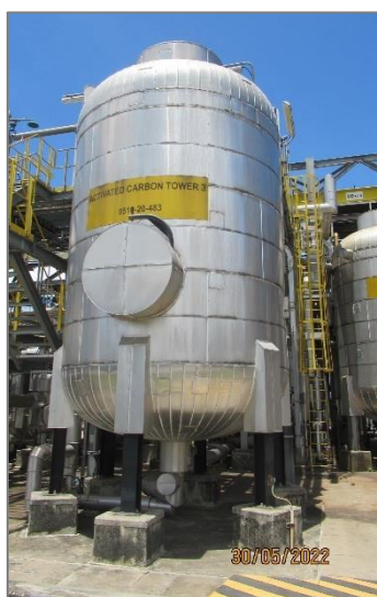
ภาพถ่ายที่ 2.2-9 หอถ่านกัมมันต์สำหรับดูดซับซัลเฟอร์
