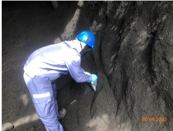
ตัวอย่างการเก็บตัวอย่างดินจากหลุมเจาะ
