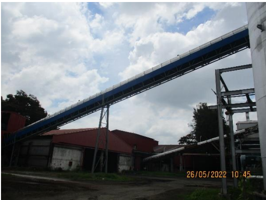
รูปที่ 6 สายพานลำเลียงเชื้อเพลิงแบบปิด
