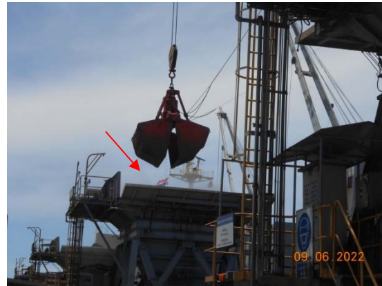
รูปที่ 8 การฉีดพ่นน้ำบริเวณปาก Hopper
