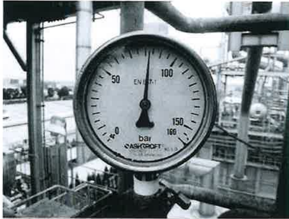
ภาพที่ 7 ภาพถ่ายแสดง Pressure Gauge ขณะทำการอัดน้ำ Hydrostatic Test เพื่อทำการทดสอบหม้อไอน้ำ สำหรับส่วน High Pressure Section ของหม้อไอน้ำ ที่ระดับ ความดัน 82.0 Bar g.
