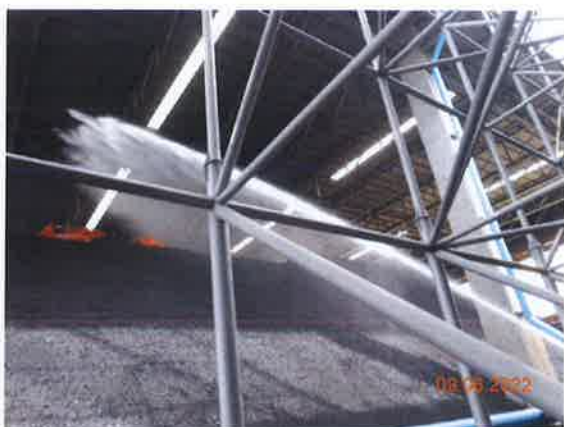
รูปที่ 9 การฉีดพรมน้ำบนกองถ่านหิน
