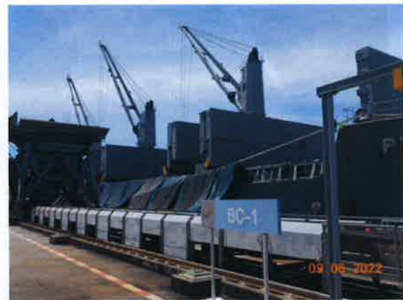
รูปที่ 5 ผ้าใบคลุมช่องว่างระหว่างหน้าท่ากับเรือ ขณะดำเนินการขนถ่ายถ่านหิน
