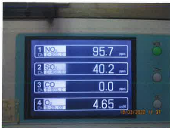
รูปที่ 18 หน้าจอ Monitor ของระบบ CEMs ขณะทำ RAA
