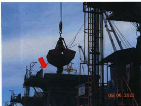
รูปที่ 4 การฉีดพ่นน้ำในระหว่างการขนถ่ายถ่านหิน
