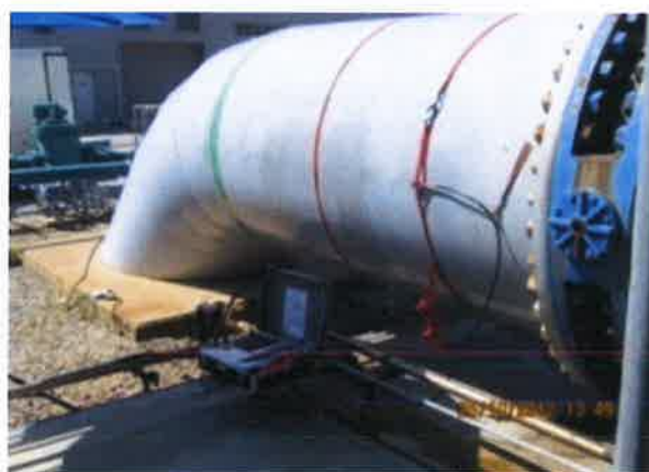
การตรวจวัดปริมาณการใช้น้ำหล่อเย็น CFB 2
