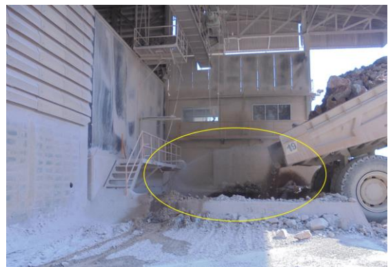
รูปที่ 10 ระบบกำจัดฝุ่นแบบ Dust Filter ในโรงโม่หินและระบบสเปรย์น้ำ
