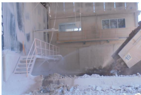
รูปที่ 10 ระบบกำจัดฝุ่นแบบ Dust Filter ในโรงโม่หินและระบบสเปรย์น้ำ
