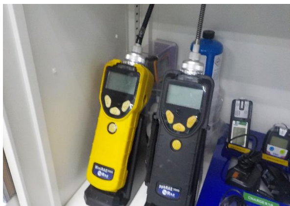
ภาพถ่ายที่ 2.2-16 เครื่องมือตรวจวัดสารอินทรีย์ระเหยง่าย (PID Gas Detector)
