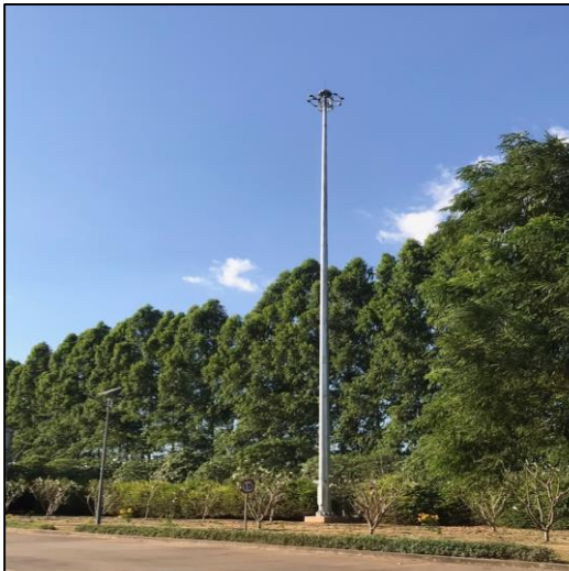
ภาพที่ 2.52 การติดตั้งเครื่องวัดกลิ่น ทิศทางลมและความเร็วลม จำนวน 2 สถานี
